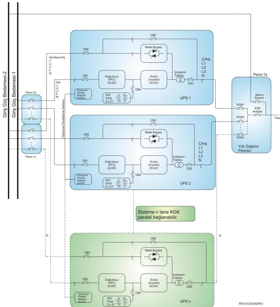
Paralel çalışma esnasında birden fazla cihazın girişi ve çıkışı birbirine bağlanmaktadır; fakat her birinin akü grubu kesinlikle ayrıdır, aküler ortak kullanılmamaktadır. Paralel sistemdeki cihazların yerleşimi ve elektriksel bağlantıları yapılrken aşağıdaki noktalar göz önünde bulundurulmalıdır:
