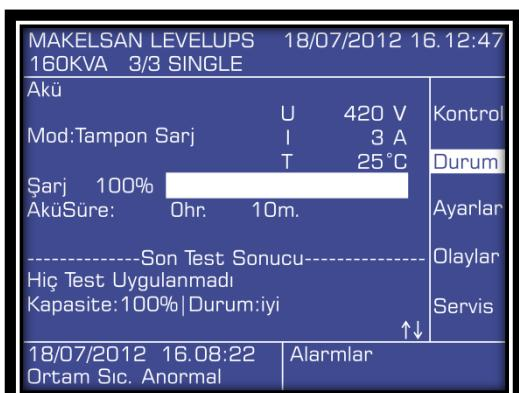
Akü durum testi, akülerin enerjisinin %10'unu kullanır ve test sonucuna göre %10'dan yüksek kapasiteli aküleri "İyi"; %10'dan düşük kapasiteli aküleri "Değiştir" olarak sınıflandırır.
