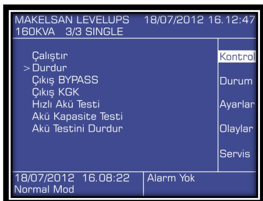
3. Ön paneldeki LED göstergeler ve LCD ekranından cihazın bypass konumuna geçtiğini görünüz.
